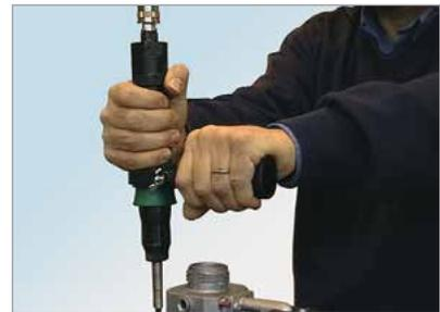
Bei den geraden Modellen 26C und 15C muss ein Klemmring angebracht werden, damit sie in einer Aufhängung mit Zusatzgriff montiert werden können.
