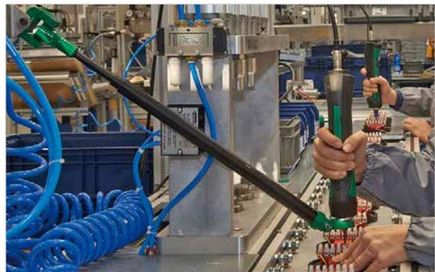
Die Teleskop-Werkzeughalter aus Magnesium können mit einer Vorrichtung zur Positionserkennung und (in Kombination mit der TPM-Überwachungseinheit) mit Spannsystemen ausgestattet werden, die für die Durchführung der Prozesse „Poka Yoke“ und die Erhöhung der Effizienz und Geschwindigkeit des Produktionszyklus äußerst nützlich sind.
